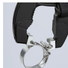
Установка хомута на шланг с упором
